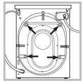
3.本機內設有一個防震盪裝置,該 裝置在運輸過程中由 4 顆螺絲釘 固定在後部(見圖)。移去4顆螺絲
