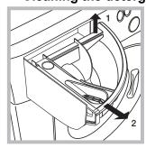
向上抽出整個容格(見圖),可用陳 舊的牙刷,把整個容格於水龍頭 下直接用水冲洗。
