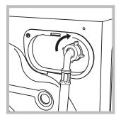
2. 進水軟管的另一端連接本機。只 需鬆開接頭配件,轉動軟管並 重新緊固接頭配件,確保不漏 水即可(見圖)。
